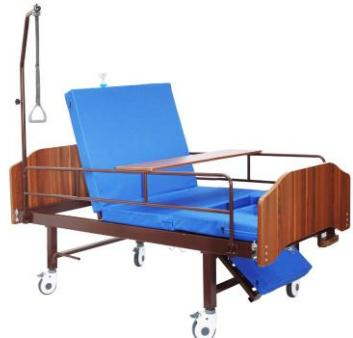
Кровать функциональная для инвалидов с принадлежностями FE-2 может принимать положение кресла для комфортного пребывания больного. Основание изделия изготовлено из прочного стального сплава и покрыто стойкой эпоксидной краской. Ножки оборудованы колесами с функцией стояночного тормоза. Ложе имеет три секции и выполнено из ламелей. Кровать оснащена механическим приводом для настройки подъема и опускания секции спины.
